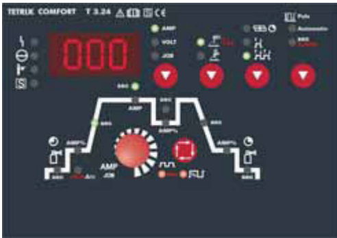
COMFORT – Beproefd comfort! Eénknopsbediening met sturing van de gebruiker voor de instelling van alle lasparameters. 8 JOB's (lastaken) door de gebruiker programmeerbaar voor steeds weerkerende lastaken
