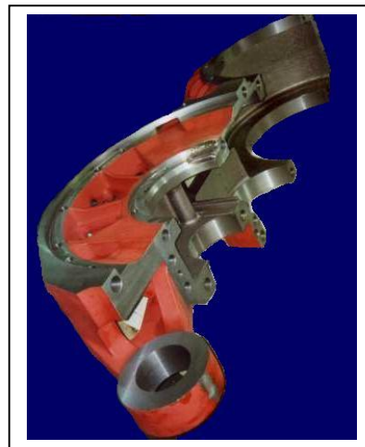
vormd. Figuur 2: Reparatie gietijzeren verdeelkast.
