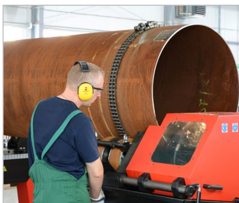
Beschermkap en de binnenverlichting verhogen de veiligheid en het comfort van de operator
