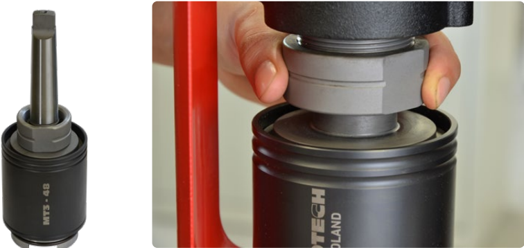
De tapkop met borgmoer beschermt het tapgereedschap tegen uittrekken
