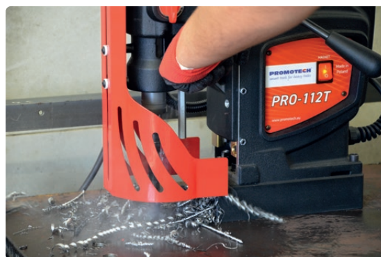
Spiraalboor max 31.75 mm (1-1/4") Maximale slag 225 mm (9")
