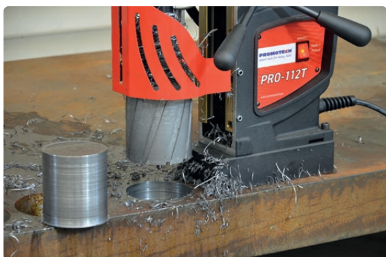
Kernboor tot 100 mm (4") Max. Boordiepte 100 mm (4")
