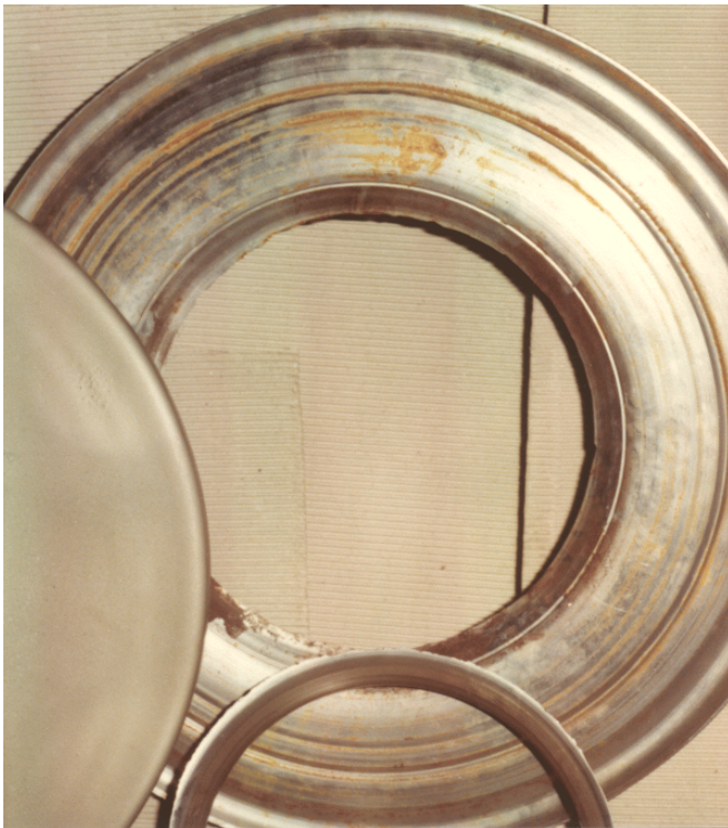
figuur 14.17 Slijtplaat van een centrifugaalpomp
