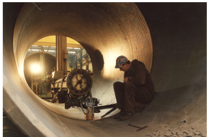
figuur 14.10 Drukvat voor de aardgasproductie
