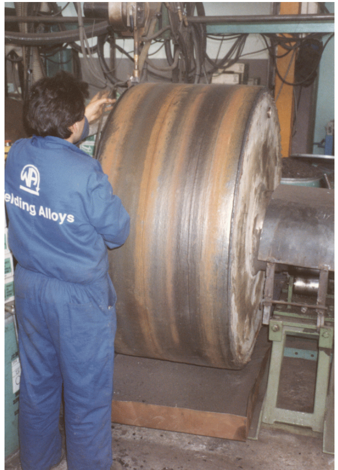
figuur 14.9 Draagrol voor roterende cementmolen
