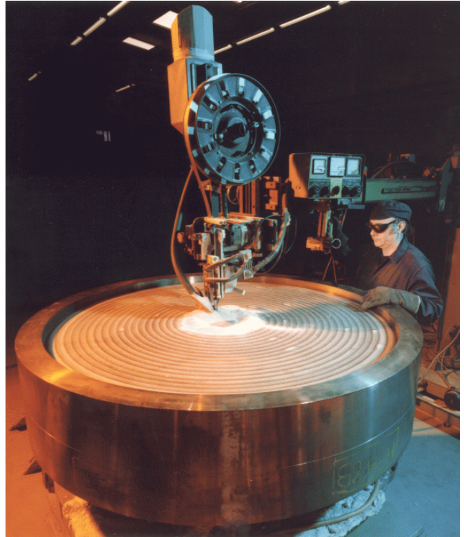
figuur 14.6 Bodem van een gaskoeler
