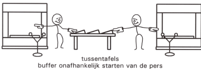
figuur 3.22 Voorbeeld producttransport van grote producten met de hand met behulp van tussentafels
