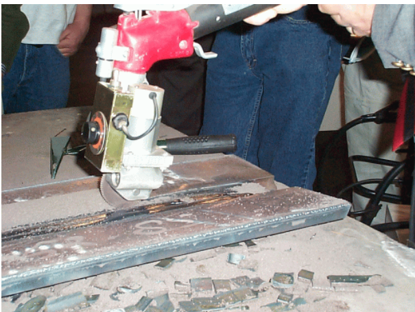
figuur 49 Half gemechaniseerd onder poeder lassen
